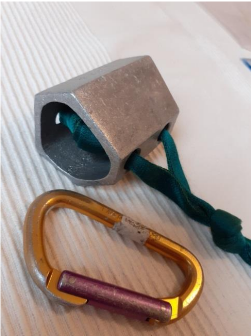
Fisurero excéntrico o también llamado empotrador excéntrico junto a un mosquetón.
